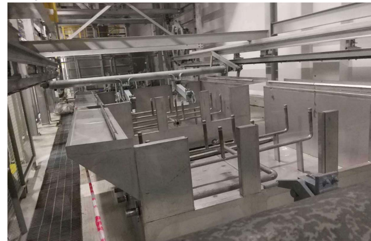
电泳RoDip翻转架容易积漆的部位的清洗方式
